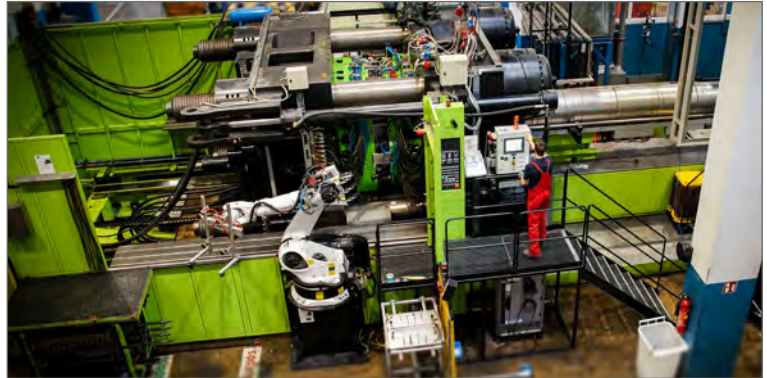
Produktion der ROMOLD Spritzgusschächte
