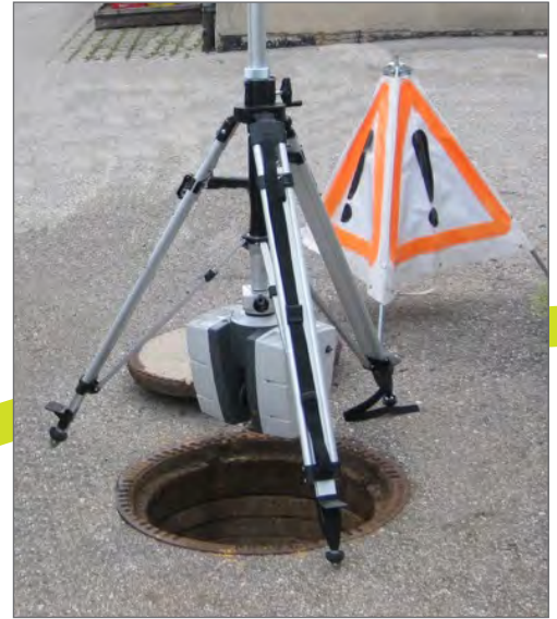
Detailliertes Schachtaufmaß idealerweise mittels Schachtscan
