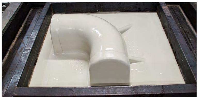
ROMOLD Produktion im Tiefziehverfahren
