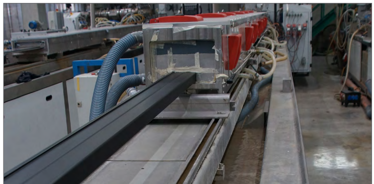
ROMOLD Produktion im Extrusionsverfahren
