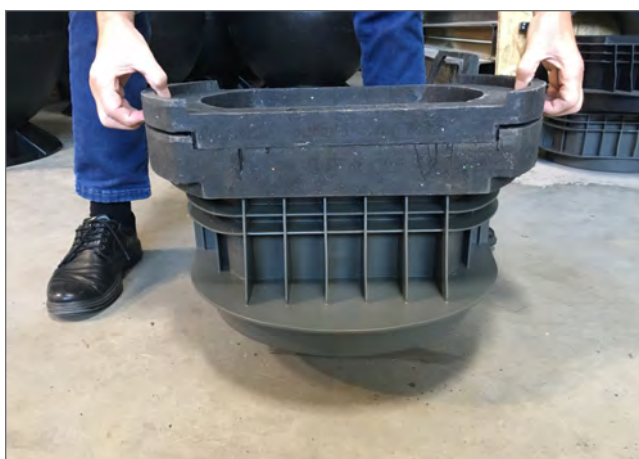
leichte Zugfestigkeit zwischen den Bauteilen vorhanden
