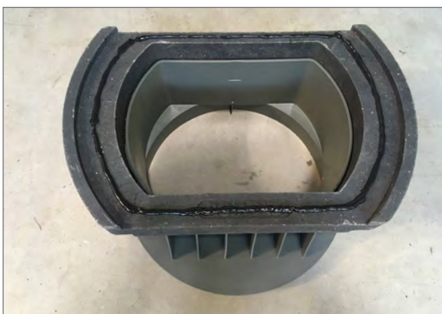
Kleber umlaufend auf PDRD 50.30/xx VS aufgetragen
