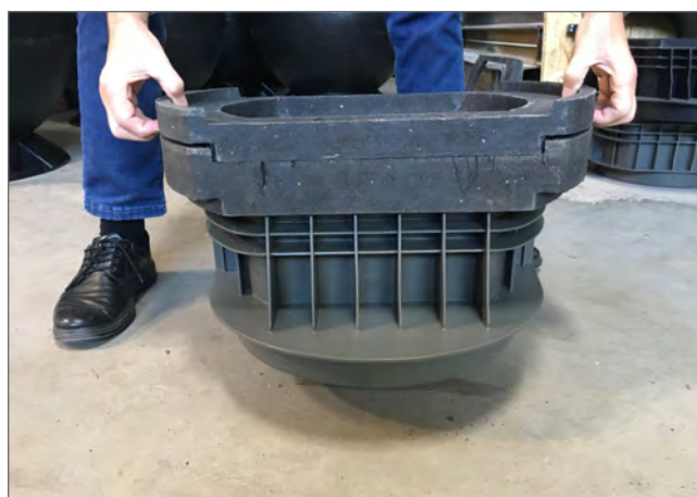
leichte Zugfestigkeit zwischen den Bauteilen vorhanden
