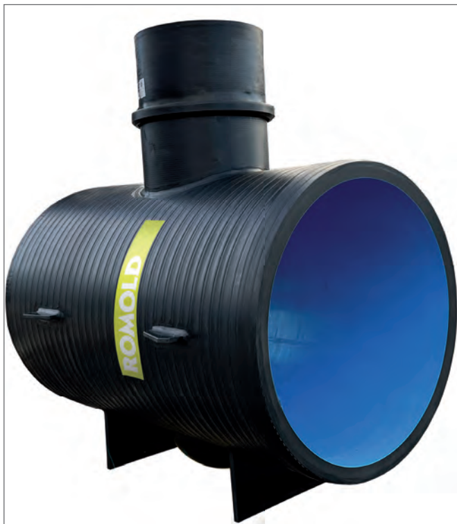
Abschlagsbauwerk für beengte Platzverhältnisse aus Rohr DN 1200 mit angeschweißtem Rundboden und Ablauf DN 200 für Normalwasseranfall, bei höherem Wasseranfall wird der Großteil im Rohr DN 1200 abgeleitet.
