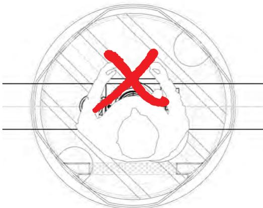
Durch eine zentrische Rohrleitungsdurchführung wird der Einstieg in den Schacht und eine Bedienung der Armaturen erschwert. Oftmals muss mit größeren Schachtdurchmessern geplant werden als notwendig.
